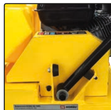
Кожух приводного ремня защищает привод от загрязнений и преждевременного износа
