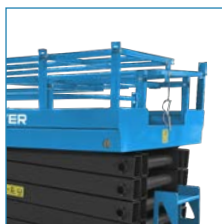
Складывающиеся поручни для удобства эксплуатации
