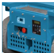
Кнопка аварийной остановки и бортовая система самодиагностики
