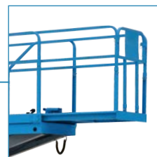
Выдвижная платформа (длина - 0.8 м, грузоподъемность - 100 кг)
