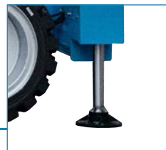
Автоматические гидравлические опоры
