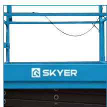
Основание рабочей платформы из стального рифленого листа
