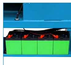
АКБ передвижения (в отсеке)
