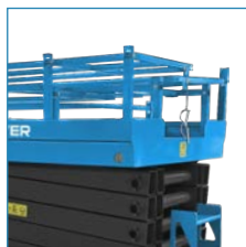
Складывающиеся поручни для удобства эксплуатации
