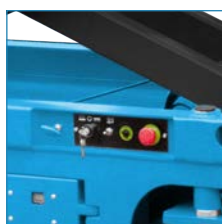
Кнопка аварийного выключения и система бортовой самодиагностики
