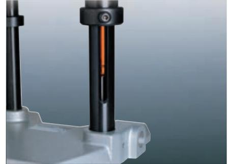
**Подъёмное устройство с газонаполненным амортизатором.**
