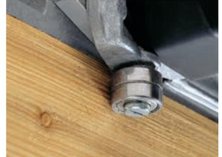
**Направляющий ролик на шарикоподшипниках.**
