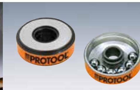
ны, увеличивается долговечность, снижаются расходы на ремонт. В угловых шлифовальных машинах стальная втулка с прецизионными стальными шариками размещается под абразивным кругом. У УШМ с автоматической балансировкой добавляется аббревиатура «АВ».
