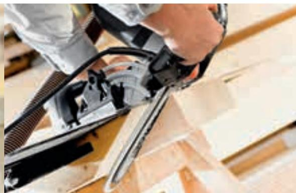
Точный пропил с соблюдением углов на глубину до 200 мм. Как в древесине, так и в твёрдых изоляционных материалах. Чистейшие косые пропилы до 60°.
