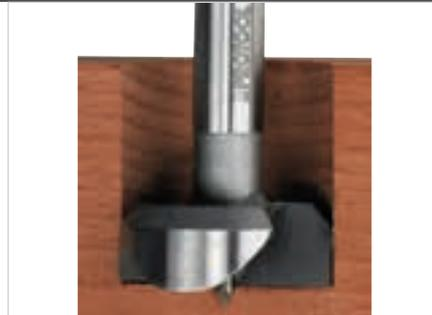
Точные ножи-подрезатели и главные режущие кромки обеспечивают такое качество поверхности, которое возможно только при работе с рубанком.
