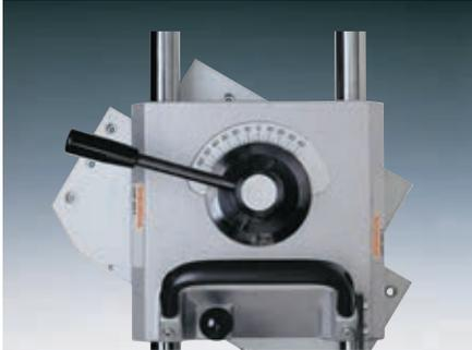
**Прорезание пазов под углом к краю балки.**
