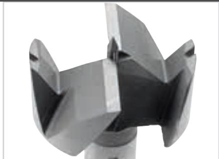
Свёрла-фрезы ZOBO изготовлены из высоколегированной, закалённой и отшлифованной хромистой стали с твёрдым хромированием поверхностей и отличаются большим ресурсом и высокой скоростью сверления.
