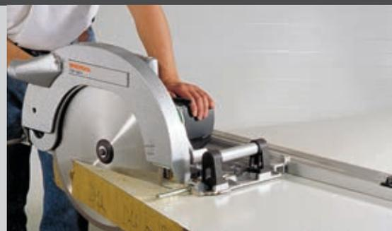
Для распила сэндвич-панелей, предназначенных для строительства павильонов, контейнеров и фасадных конструкций. С системой шин-направляющих и специальным пильным диском. Толщина стальной заготовки не более 2 мм.
