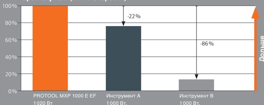
Измерение срока службы редуктора до выхода из строя при длительном использовании. Нагрузка соответствует смешиванию вязкого и тяжёлого материала. Источник: испытательная лаборатория PROTOOL 2010 г.
