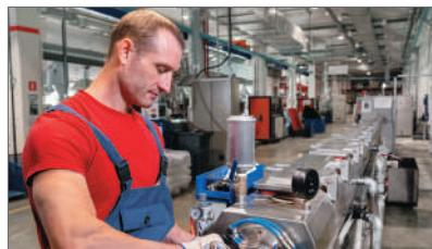
Линии для экструдирования термоусаживаемой трубы
