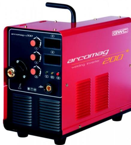
Сварочный инверторный аппарат ARComag-200 разработан для проведения полуавтоматической сварки сплошной или порошковой проволокой в среде защитных газов (CO<sub>2</sub>, Ar, смесь CO<sub>2</sub>+Ar) а также, самозащитной порошковой проволокой без применения защитной газовой среды.
