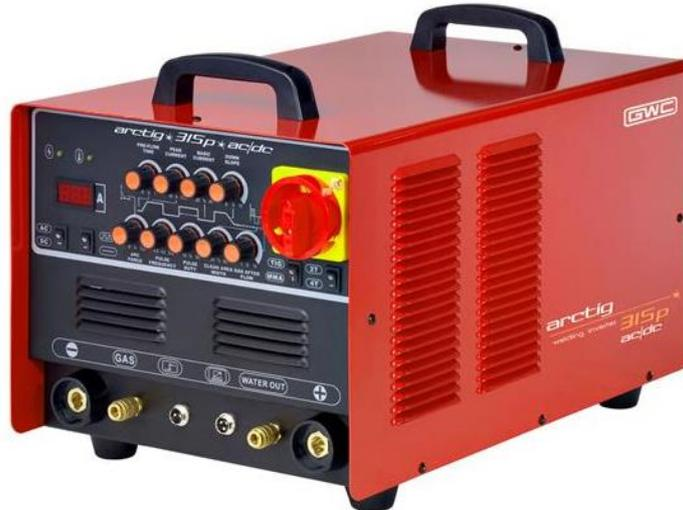
Сварочный аппарат инверторного типа ARCTIG-315P разработан для аргодуговой сварки неплавящимся вольфрамовым электродом в среде защитных газов на постоянном токе, а также для ручной дуговой сварки покрытыми электродами.
