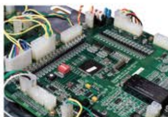
Цифровой микропроцессор DSP нового поколения позволяющий работать в режиме многозадачности
