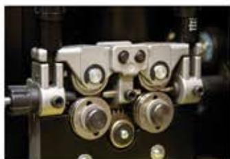
Надежный промышленный 4-х роликовый механизм протяжки
