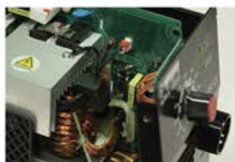
Компактное расположение электронных компонентов для снижения веса аппарата
