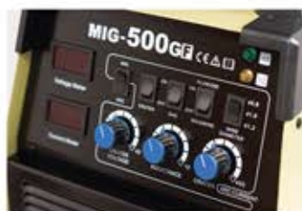
Возможность выбора типа сварочной проволоки и плавная регулировка индуктивности
