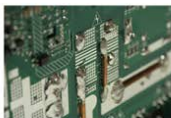
Дорожки силовой платы усилены медными шинами
