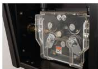
Промышленный 4-х роликовый механизм подачи проволоки с дополнительной защитой от загрязнений
