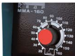
Главная регулировка сварочного тока
