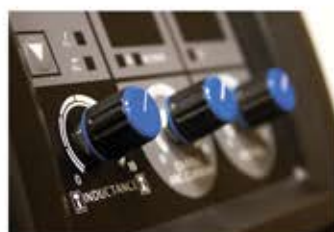
Главная регулировка индуктивности
