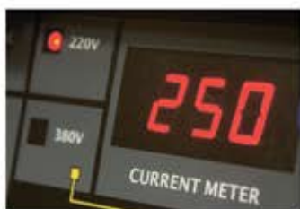
Цифровой дисплей для предустановки сварочного тока
