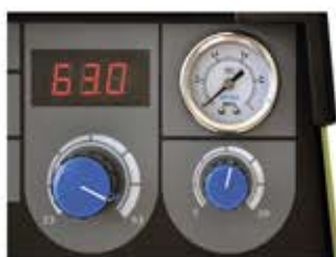
Манометр на передней панели для точной регулировки давления воздуха
