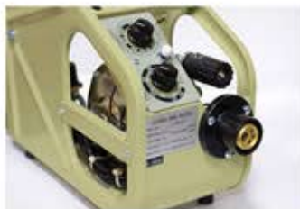
Облегченный механизм подачи проволоки открытого типа
