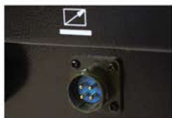
Разъем подключения пульта ДУ
