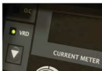
Функция снижения напряжения холостого хода
