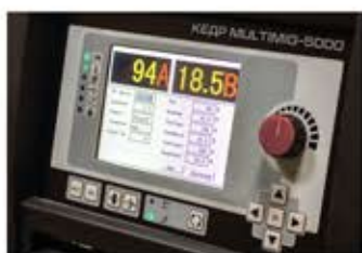
Полностью цифровое управление с жидкокристаллическим дисплеем
