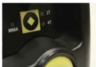
Выбор 2-х и 4-х тактного режима сварки
