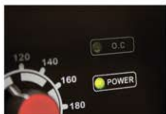
Индикаторы включения в сеть и защиты
