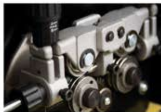
Надежный 4-х роликовый механизм протяжки проволоки
