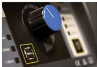
Регулировка индуктивности и напряжения в режиме синергетики
