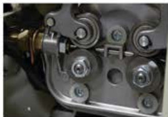
Мощный 4-х роликовый механизм промышленного типа
