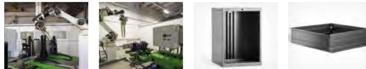
Корпуса тумб и ящики полностью сварные. Применение роботизированных сварочных комплексов гарантирует неизменно высокий уровень качества.
