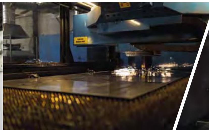
Лазерный станок позволяет вырезать сложные детали.
