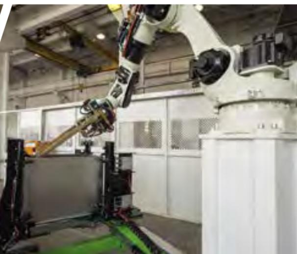
В цехе работают три сварочных комплекса. Эти роботы обеспечивают высокую скорость и точность сварки.
