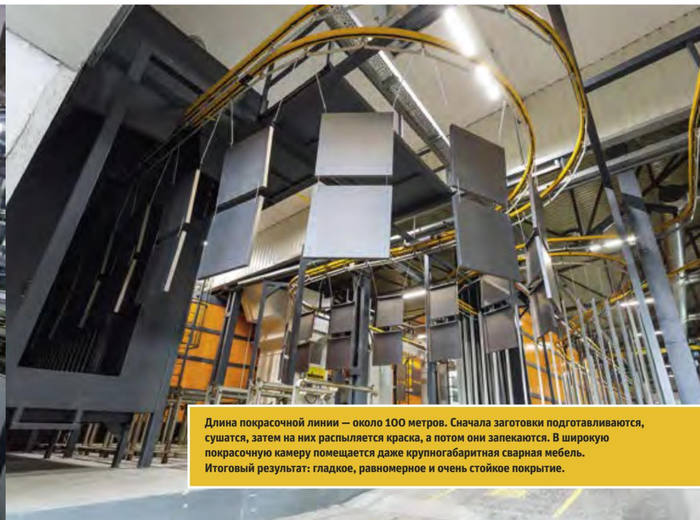
Длина покрасочной линии — около 100 метров. Сначала заготовки подготавливаются, сушатся, затем на них распыляется краска, а потом они запекаются. В широкую покрасочную камеру помещается даже крупногабаритная сварная мебель. Итоговый результат: гладкое, равномерное и очень стойкое покрытие.
