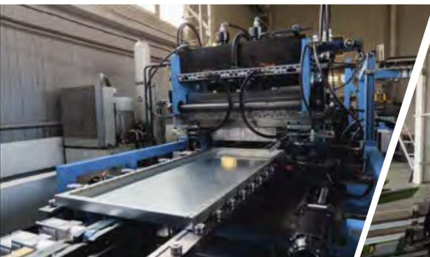
Стеллажи изготавливаются на станках полного цикла. Длина станка — 56 метров. Производительность — 12 полок в минуту.
